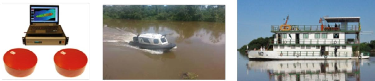
**Figura 3.** À esquerda, ecobatímetro multifeixe EM 2040 Kongsberg *dual head*. No centro, lancha de sondagem equipada com o sistema multifeixe. À direita, embarcação de apoio: Navio Hidroceanográfico Fluvial Caravelas.
