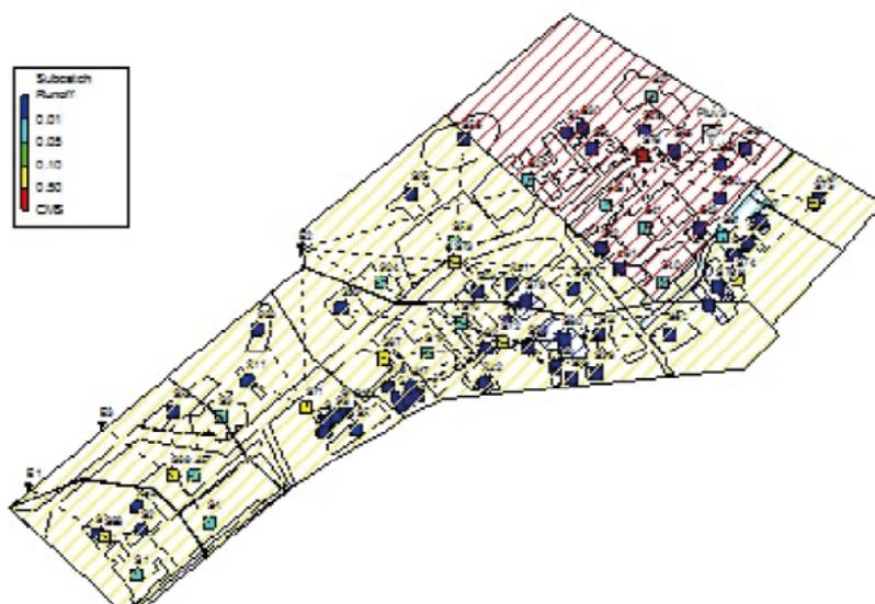
**Figura 7.** Mapa gerado pelo SWMM ao final da modelagem apresentando telhados convencionais.
