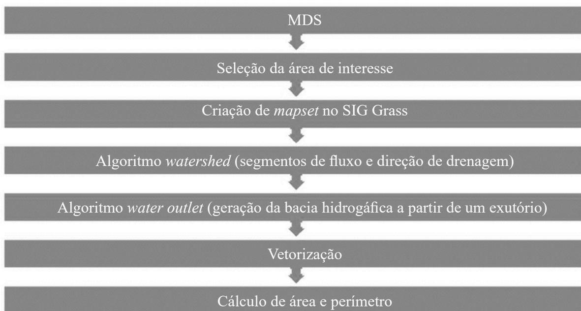
**Figura 2.** Fluxograma para delimitação de Bacia Hidrográfica pelo QGIS 2.14.0 (QGIS Development, 2015).
