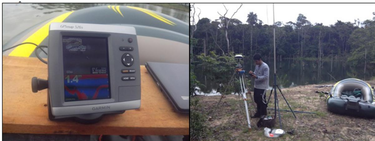
**Figura 1.** Visualização da tela do GPSMAP526S sobre o perímetro da lagoa e calibração do RTK em campo.
