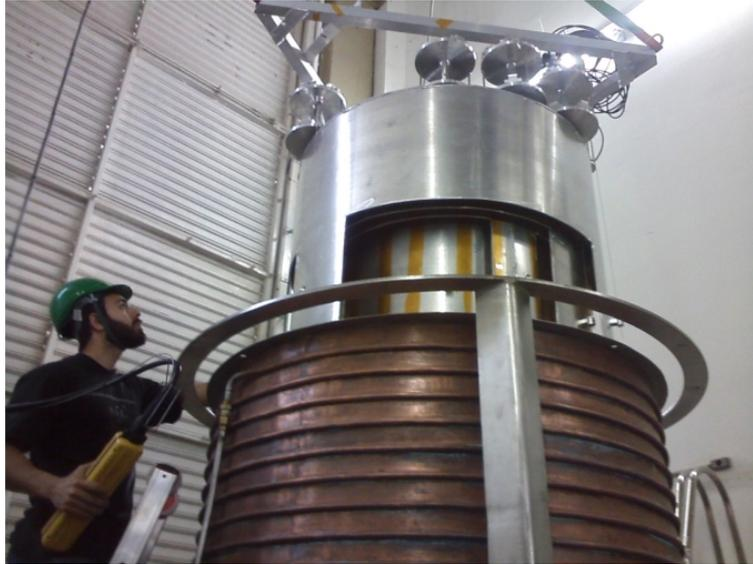
O sistema é suspenso pela estrutura triangular, que é apoiada no anel de suporte da câmara de vácuo. A suspensão é controlada pela ponte rolante.
