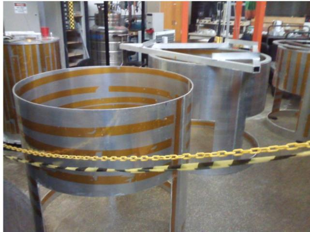
As três cascas cilíndricas dos estágios mais externos agora possuem aberturas em formato retangular com a principal finalidade de permitir o acesso manual aos novos pontos de suspensão.
