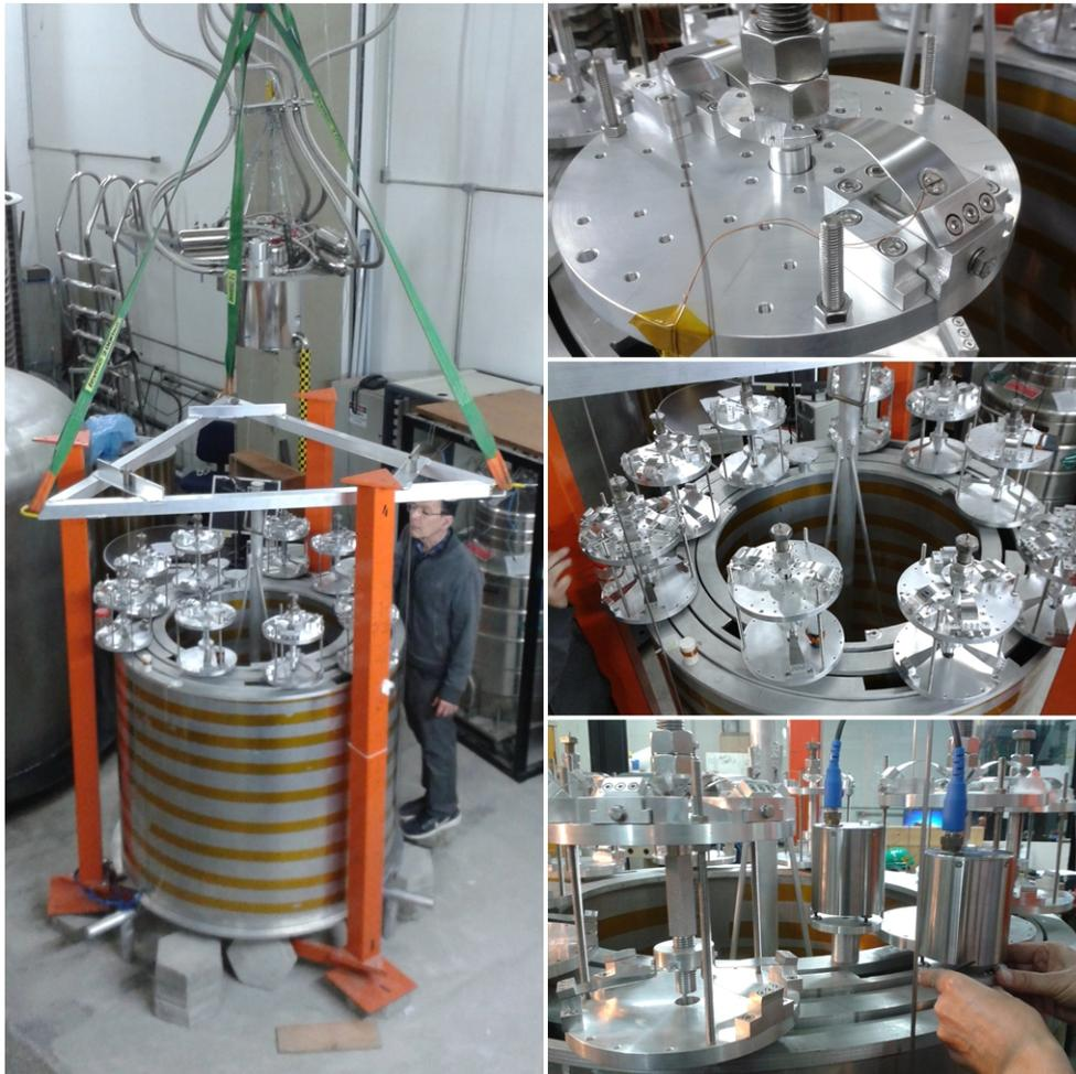
Montagem do MNP de quatro estágios com as GAS e preparação para o experimento. Coluna da esquerda: o sistema montado e suspenso. Coluna da direita, em cima: GAS de duas lâminas para suspender o 4º estágio; no meio: conjunto das 9 GAS; em baixo: dois sismômetros MBB-1 instalados para medição de vibrações.
