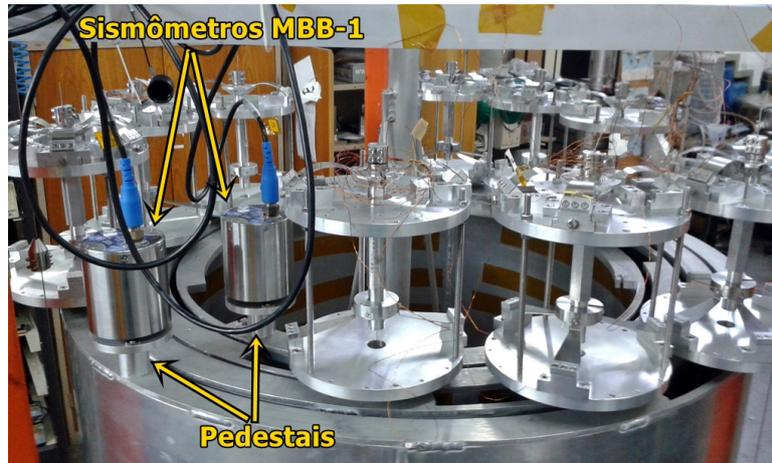
Sismômetros MBB-1 instalados sobre os pedestais de alumínio, presos nos flanges dos estágios interno e externo do MNP.
