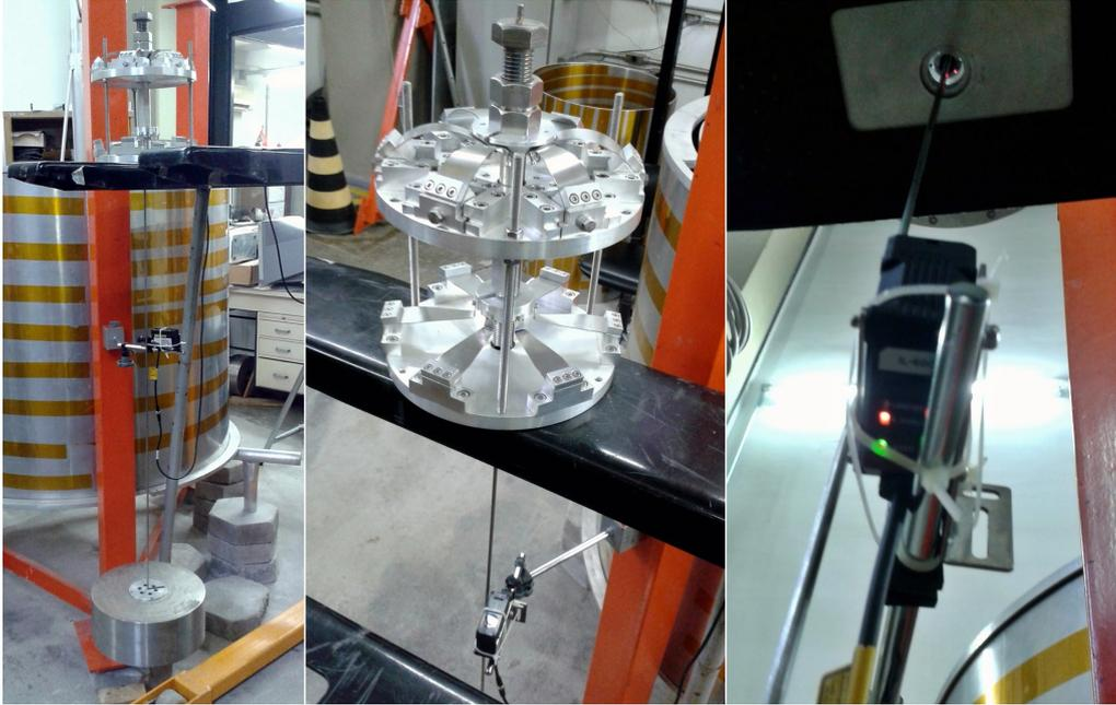
Fotografias do experimento para medir o sinal de resposta do protótipo GAS usando um sensor a *laser*. O sensor era posicionado perto da haste e apontando para cima, para a parte de baixo da peça de conexão central dos estágios. A base da GAS era apoiada em um garfo de uma empilhadeira.
