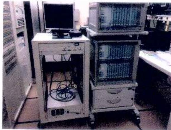
Figura 8 – Rack SISTESH e Condicionador de Sinais (*Strain Gage*).
