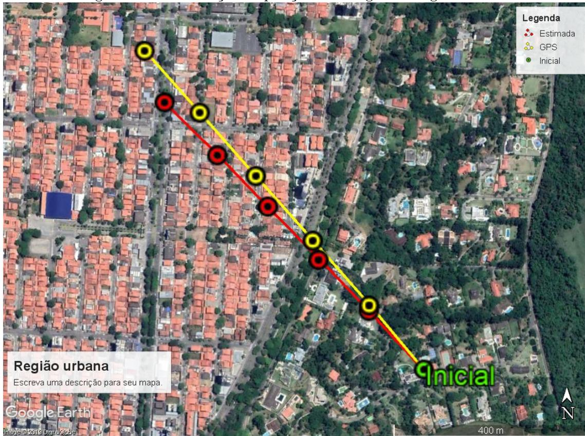
O marcador verde indica a posição inicial do GPS, os marcadores e a linha amarela indicam a posição real do GPS e os marcadores e a linha vermelha indicam a posição estimada do algoritmo.
