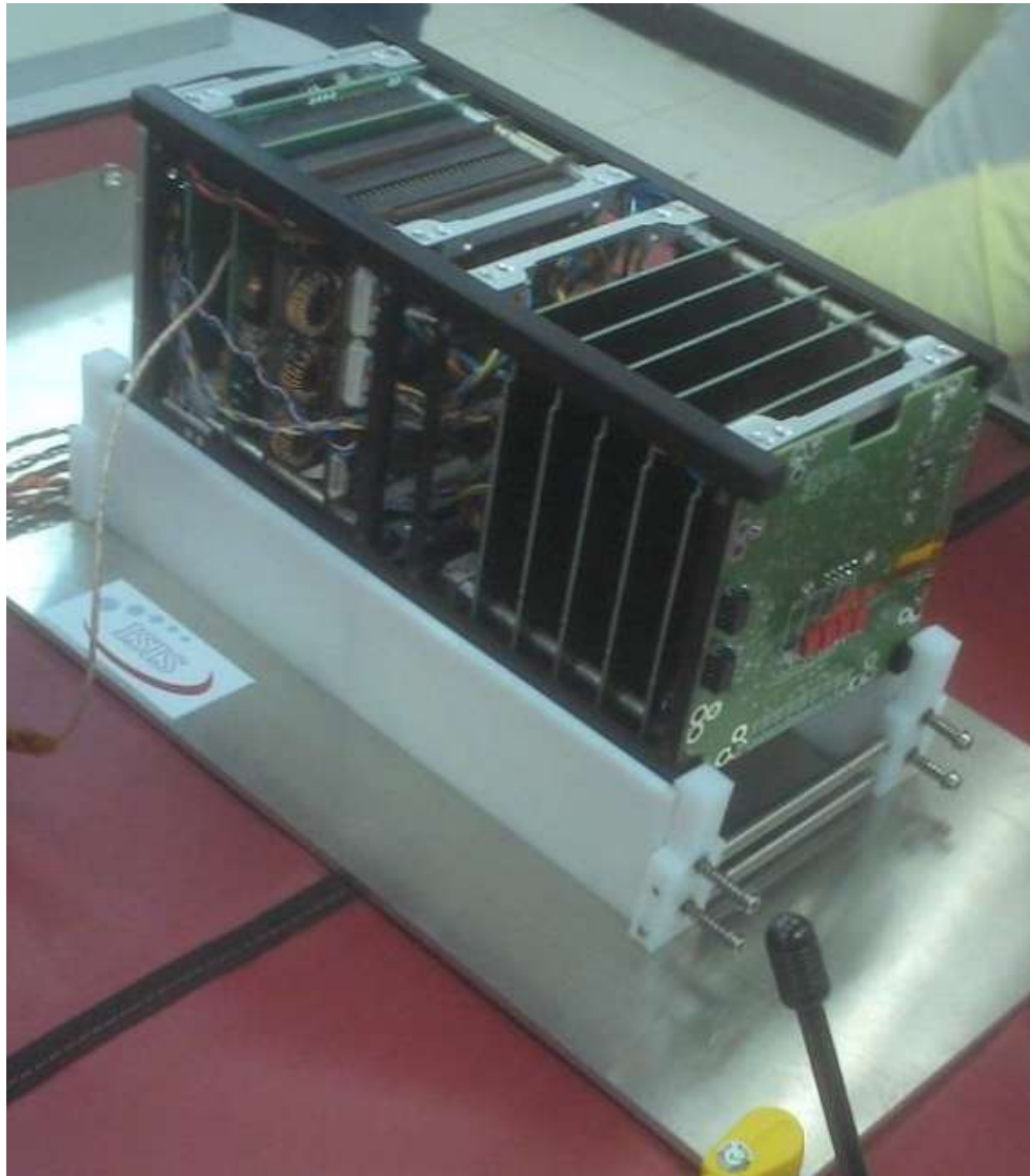
Figura 2: Foto do modelo de engenharia do CubeSat NANOSATC-BR1 no Laboratório de Integração e Testes (LIT/INPE-MCTIC)
