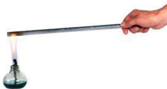
Figura 12: Condução de energia em uma barra de metal
