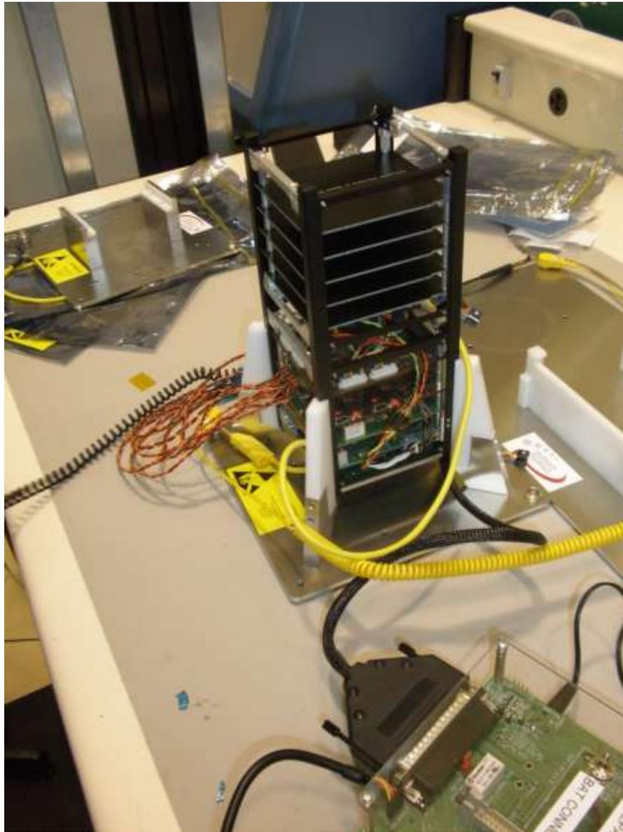
**Figura 2: Modelo de Engenharia da plataforma 2U do NANOSATC-BR2 em bancada**
