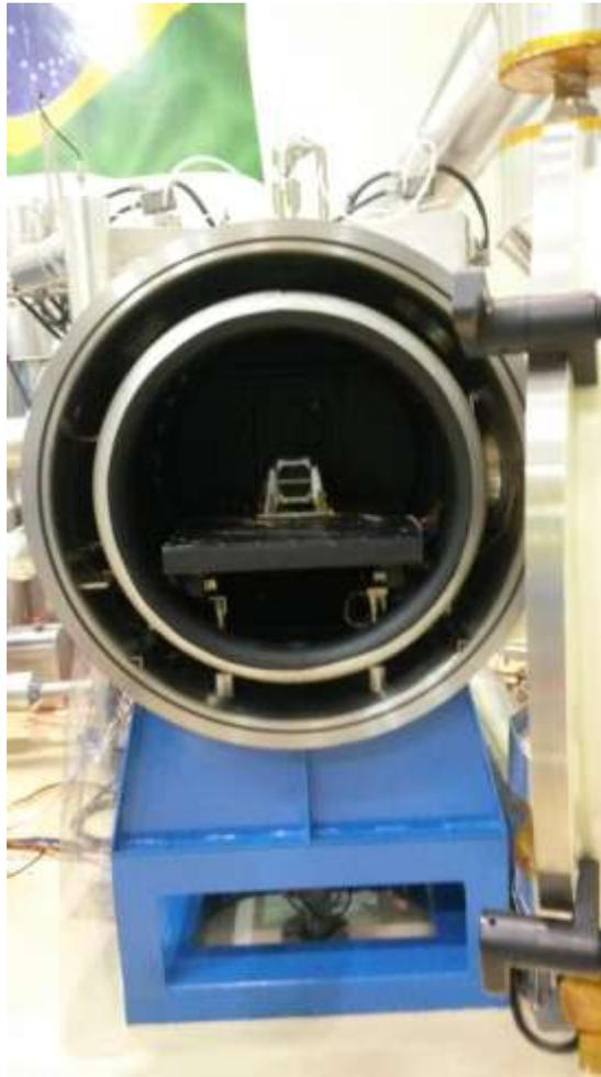
**Figura 15: Teste termo vácuo do satélite NANOSATC-BR1, no Laboratório de Integração e Testes – LIT/INPE-MCTIC, em São José dos Campos, SP.**
