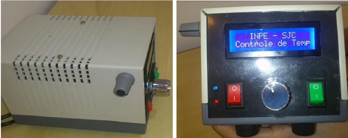
**Figuras 18 e 19** – Caixa protetora com os circuitos funcionando
