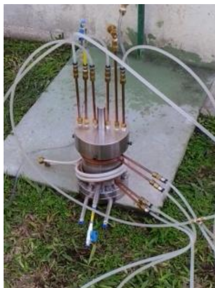
Figura 3.5 1: Teste estaquiedade de água
