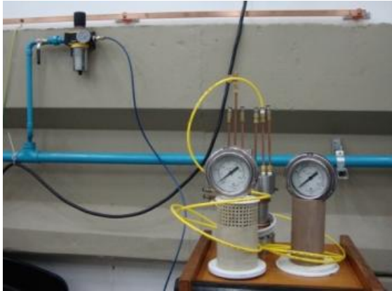
Figuras 3.4. 1 e 3.4. 2 : Teste de estanquidade de gás
