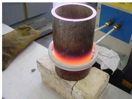
Figura 1.2.1. 5: aquecimento da bobina
