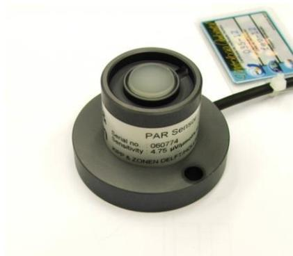
Figura 2.7 - Radiômetro PAR.
