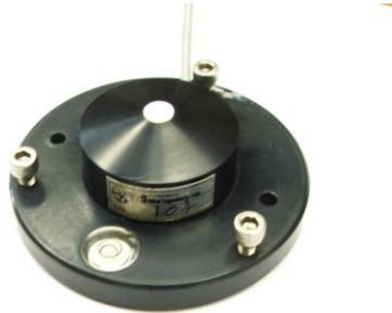
Figura 2.6 – Radiômetro protótipo CELSOL.
