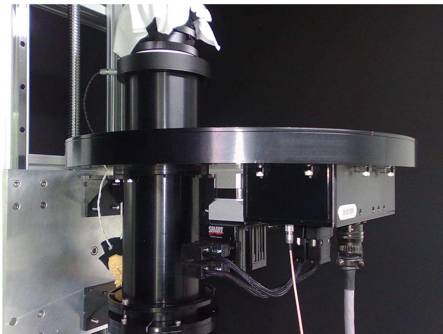
Figura 4.3.2 - A roda de filtros de interferência. Sob a mesma, encontra-se uma unidade eletrônica de controle.
