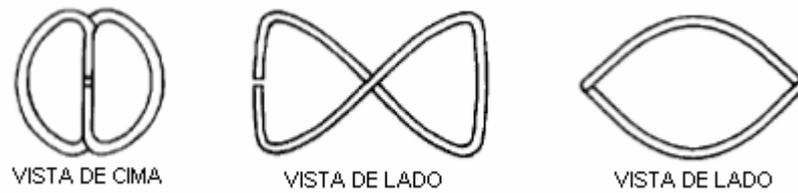
Fig. 5.3 – Vistas da antena bifilar
