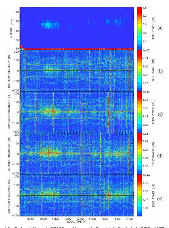
Fig. 6.5 – Dados obtidos pelo RESCO no Observatório Espacial de São Luís do INPE - MCT para o dia 19 de novembro de 2003: (a) Mapa RTI; Espectrogramas referentes à altura de (b) 100,0 km; (c) 102,6 km; (d) 105,2 km; e (e) 107,8 km. Dados reduzidos e analisados no âmbito da Parceria INPE-UFSM, no Centro Regional Sul de Pesquisas Espaciais, CRSPE/INPE - MCT, em Santa Maria, RS.
