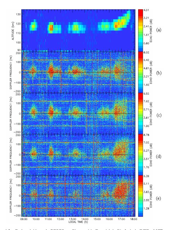
Fig. 6.2 – Dados obtidos pelo RESCO no Observatório Espacial de São Luís do INPE - MCT para o dia 20 de outubro de 2003: (a) Mapa RTI; Espectrogramas referentes à altura de (b) 102,6 km; (c) 105,2 km; (d) 107,8 km; e (e) 110,4 km. Dados reduzidos e analisados no âmbito da Parceria INPE-UFSM, no Centro Regional Sul de Pesquisas Espaciais, CRSPE/INPE - MCT, em Santa Maria, RS.
