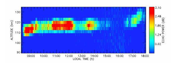
Fig. 4.3 – Exemplo de mapa de variação temporal de intensidade de potência em função da altura obtido pelo RESCO no Observatório Espacial de São Luís do INPE - MCT para o dia 17 de outubro de 2003.
