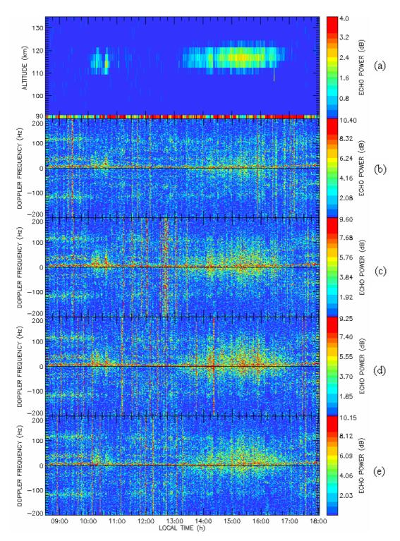
Fig. 6.4 – Dados obtidos pelo RESCO no Observatório Espacial de São Luís do INPE - MCT para o dia 18 de novembro de 2003: (a) Mapa RTI; Espectrogramas referentes à altura de (b) 100,0 km; (c) 102,6 km; (d) 105,2 km; e (e) 107,8 km. Dados reduzidos e analisados no âmbito da Parceria INPE-UFSM, no Centro Regional Sul de Pesquisas Espaciais, CRSPE/INPE - MCT, em Santa Maria, RS.
