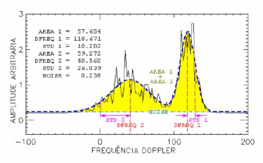
Fig. 4.4 – Espectro de freqüência simulado (em preto) e seu ajuste por Gaussianas (em azul). A linha tracejada vermelha indica o centro da distribuição, a linha verde indica o nível de ruído e a diferença entre as linhas vermelha e violeta indica os respectivos desvios padrões.
