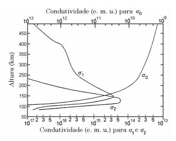
Fig. 2.3 – Perfil de condutividade mostrando a variação das condutividades longitudinal  $\sigma_0$ , Pedersen  $\sigma_1$  e Hall  $\sigma_2$  com a altura. Para conversão 1 e.m.u. (cgs) =  $10^{11}$  S/m (SI). FONTE: Akasofu e Chapman (1972, p. 244).
