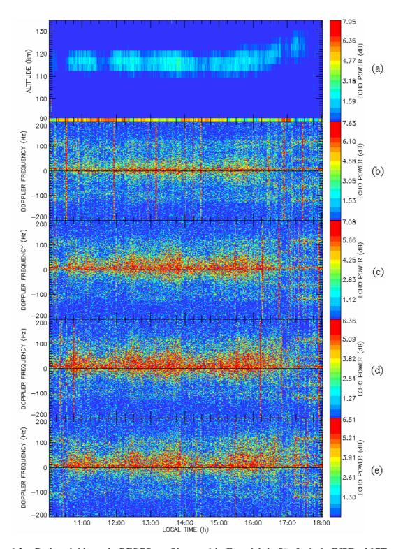
Fig. 6.3 – Dados obtidos pelo RESCO no Observatório Espacial de São Luís do INPE - MCT para o dia 17 de novembro de 2003: (a) Mapa RTI; Espectrogramas referentes à altura de (b) 100,0 km; (c) 102,6 km; (d) 105,2 km; e (e) 107,8 km. Dados reduzidos e analisados no âmbito da Parceria INPE-UFSM, no Centro Regional Sul de Pesquisas Espaciais, CRSPE/INPE - MCT, em Santa Maria, RS.
