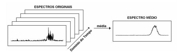
Figure 4.5 – Ilustração de integração incoerente aplicado aos 100 espectros consecutivos da esquerda e o seu resultado ao lado direito.
