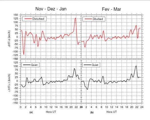
Figura 3 - Variação horária da velocidade de deriva vertical (Δh'F / Δt ) obtida a partir dos dados de digissonda analisados para os períodos de (a) novembro, dezembro e janeiro e (b) fevereiro e março sob condições calma (linha preta) e perturbada (linha vermelha).
