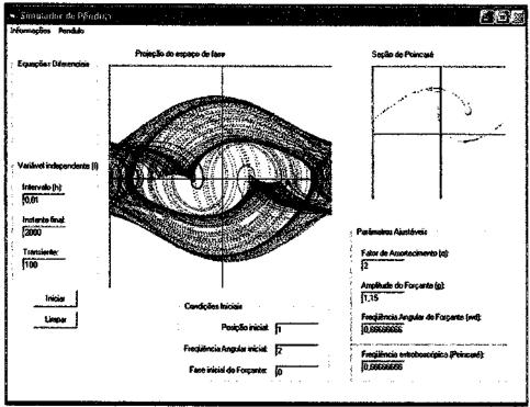
Note que o movimento e completamente irregular e imprevisível, observando a seção de Poincaré, temos que esta apresenta uma geometria fractal. Temos o comportamento caótico.
