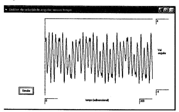
Conforme esperávamos, temos que o último sistema apresenta oscliações não regulares de valores de sua velocidade angular. Assim, podemos estabilizar o sistema através da adição do forçante adicional.
