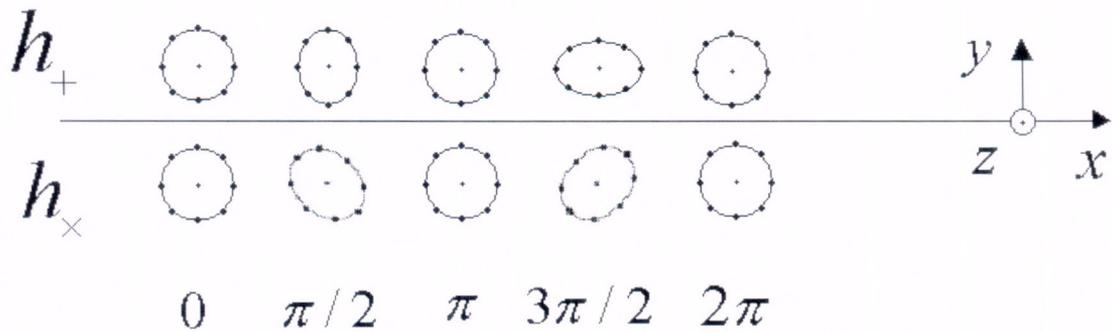
Figura 1: Distorção de uma circunferência de partículas livres devido a forças induzidas pela passagem de uma onda gravitacional com polarização  $h_+$  ou  $h_\times$ .
