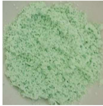
Figura 23 – Catalisador úmido após a 1ª impregnação
