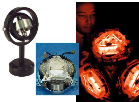
Figura C.10 - Giroscópios mecânicos, de fibra óptica e a laser.
