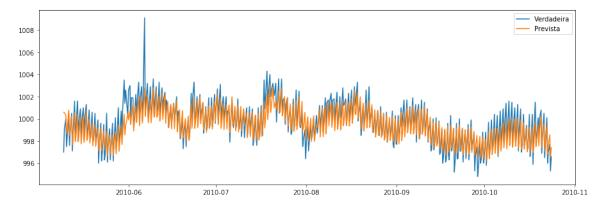
Figura 7. Resultado da imputação de dados com a rede GRU para cidade Monte Alegre, em laranja os valores previstos pelo modelo (Model02 - GRU) e em azul os dados reais observados.
