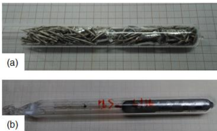
Figura 8 - (a) Exemplo de elementos puros na ampola; (b) PbSn após selagem da ampola.
