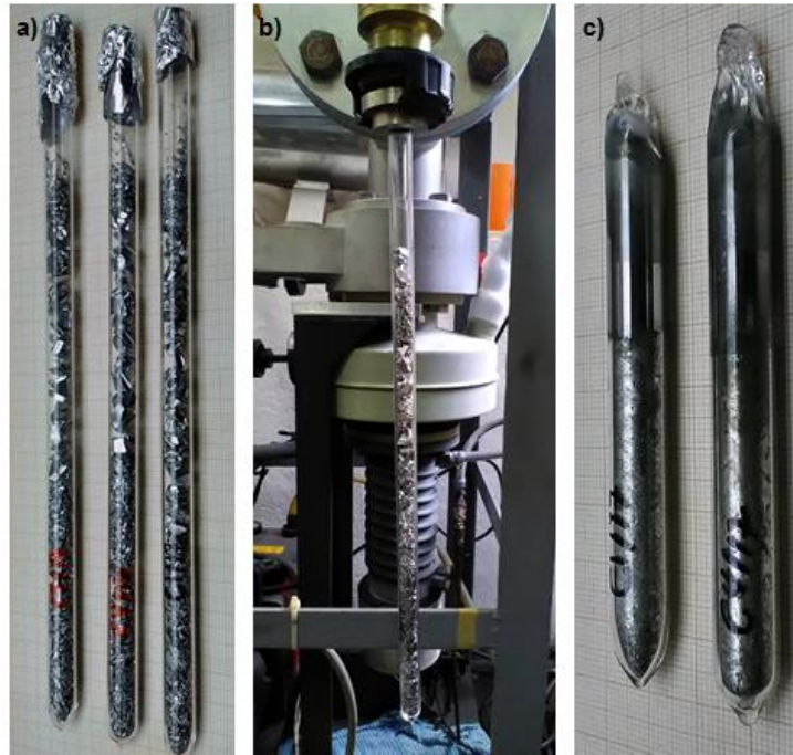
Figura 9 - (a) Cargas de PbSn divididas em novas ampolas; (b) selamento; (c)ampolas fechadas.
