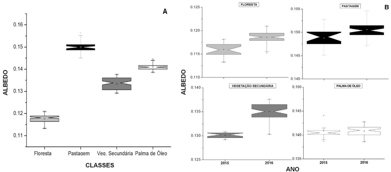
**Fig. 3** - Diagrama de caixa do  $\alpha$  para diferentes usos e coberturas do solo estimado com sensor MODIS pelo teste não paramétrico de Kolmogorov-Smirnov ( $P \leq 0.05$ ). A) Uso e coberturas do solo com diferença significativa ao comparar as médias dos dois anos de estudo. B) Médias dos valores de  $\alpha$  para cada uso e cobertura do solo nos anos de 2015 e 2016.
