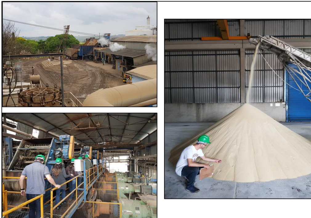
Figura A.7: Usina de processamento de Cana-de-Açúcar da Família Granelli. No canto esquerdo superior, caminhões com carga sendo tombados. No canto inferior: extração do caldo. À direita, resultado do processo: açúcar.
