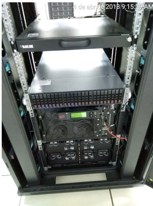
Fig. 05 – No helios, placa de patrimônio, nós computacionais, unidade de armazenamento e a porta da unidade.
