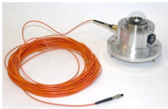
Figura 2 – Interface Óptica desenvolvida em laboratório para a coleta dos dados espectrais.
