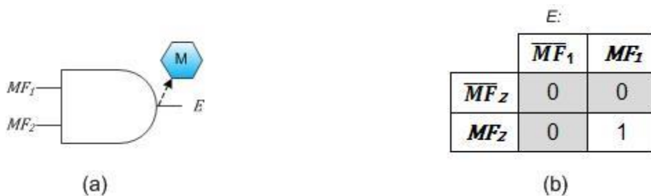
Figura 3.20 – (a) Efeito monitorado EM causado pela propagação conjuntiva de MF_1 e MF_2 ; (b) Mapa de Karnaugh para o efeito E .
