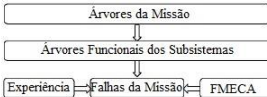
Figura 2.20 – Fluxo de trabalho para definição do repertório de falhas da missão WISE.
