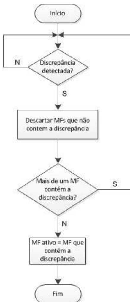
Figura 3.29 – Fluxograma básico para isolamento e/ou identificação com critério de biunivocidade.
