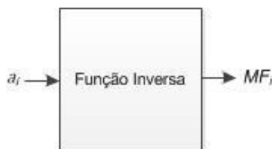
Figura 3.10 – Representação da identificação do modo de falência ativo a partir de sua assinatura.
