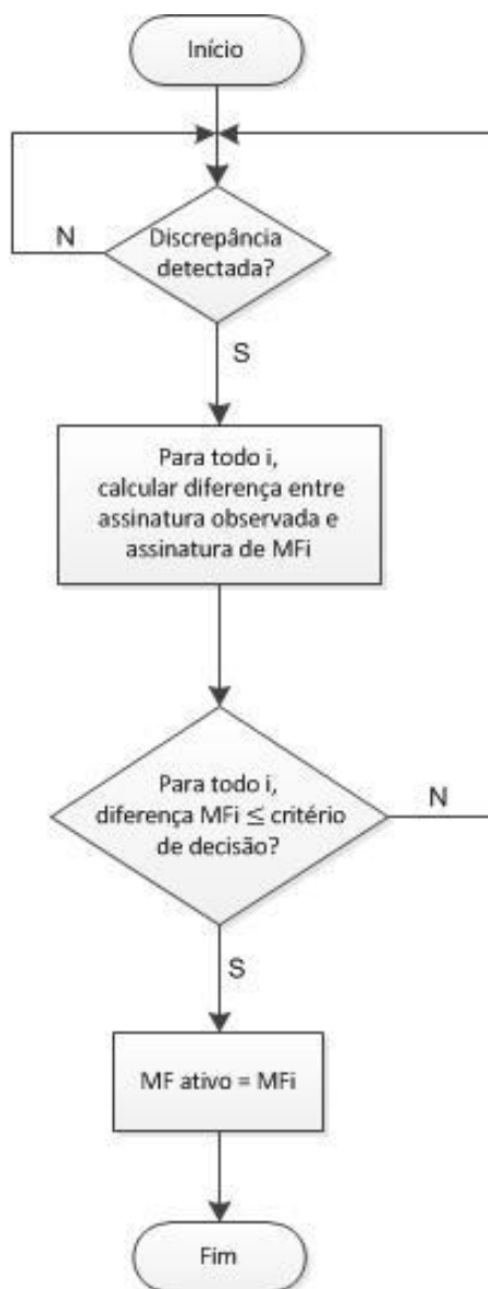
Figura 3.26 – Fluxograma básico de lógica acionada por evento para isolamento e/ou identificação por diferença de assinaturas.
