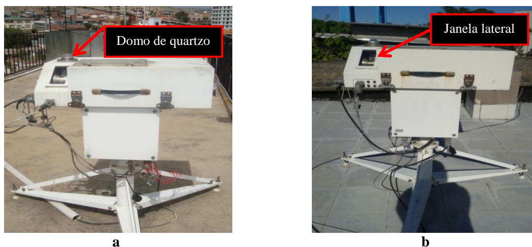
Figura 1. Espectrofotômetro Brewer: (a) em La Paz–Bolívia, no laboratório de física da “Universidad Mayor de San Andrés” e (b) em Natal – RN, Brasil, no Laboratório do Instituto Nacional de Pesquisas Espaciais – Regional Nordeste.
