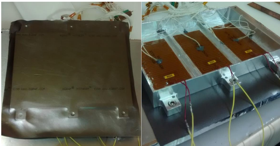
Figura 3.2 - Instalação do eGraf® Hitherm™ 1200
