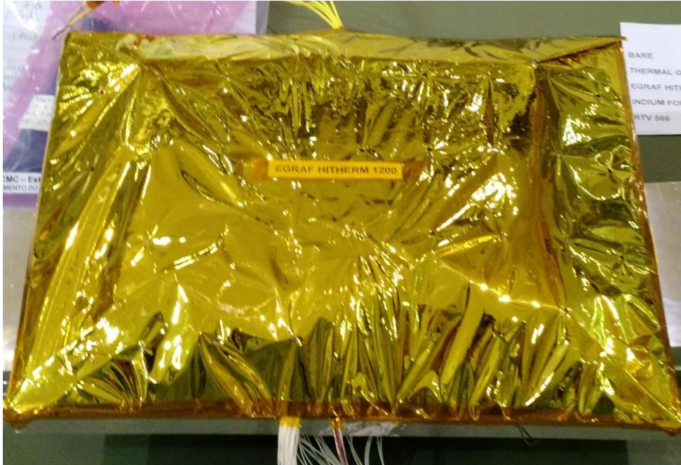
Figura 5.7 – Fotografia de um dos conjuntos já montado com MLI
