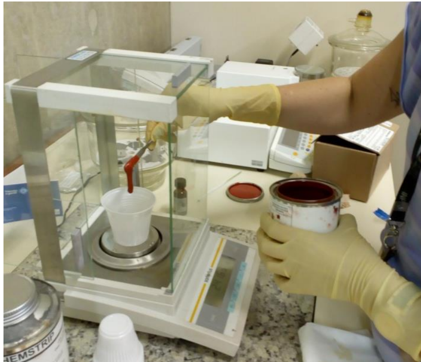
Figura 3.8 – Mistura de resina com catalisador é realizada com o uso de uma balança
