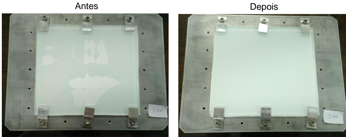
Figura 4.6 – Graxa térmica em pressão ambiente: antes e depois do vácuo
