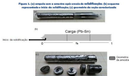
Figura 2. (a) ampola com a amostra após ensaio de solidificação; (b) esquema representado o início da solidificação; (c) geometria da seção caracterizada
