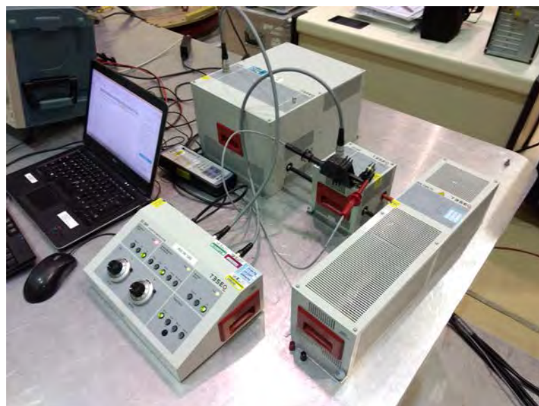
Figura 7 – Calibração de tempo de subida do pulso com carga de alta potência
