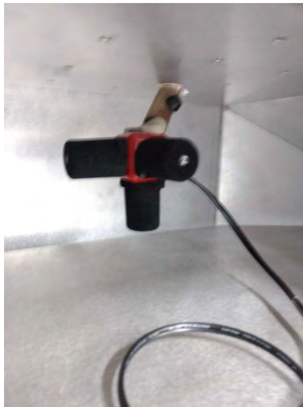
Figura 2 – Posicionamento do sensor no interior da Célula TEM
