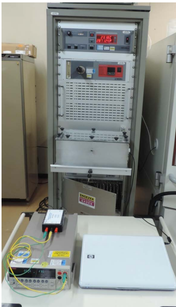
Figura 10. Sistema de calibração utilizando o dispositivo de fixação
