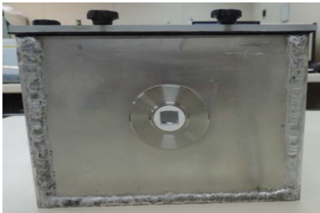
Figura 6. Dispositivo para fixação e calibração de medidores de umidade – Vista lateral direita
