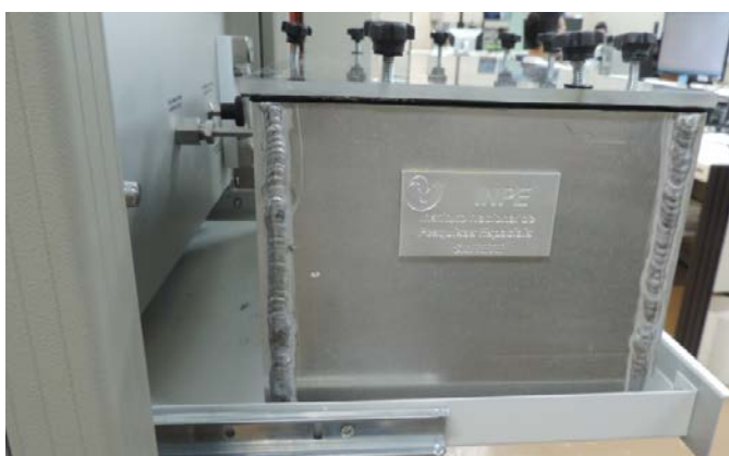
Figura 7. Dispositivo para fixação e calibração de medidores de umidade – Vista lateral esquerda
