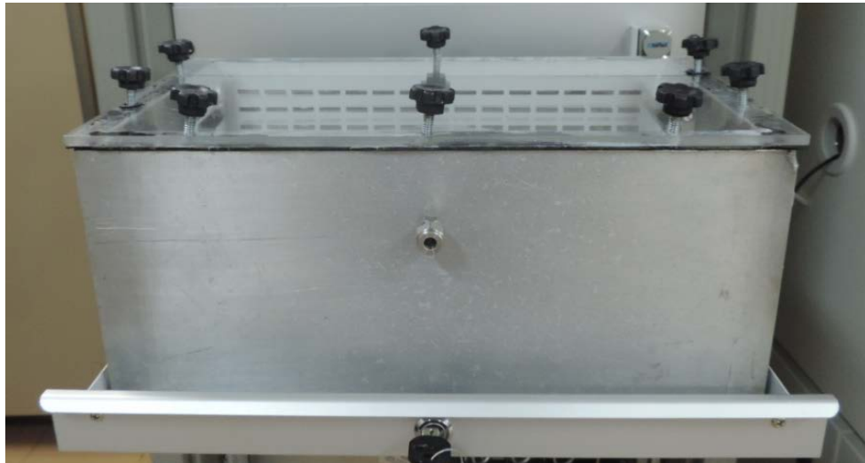
Figura 4. Dispositivo para fixação e calibração de medidores de umidade – Vista frontal
