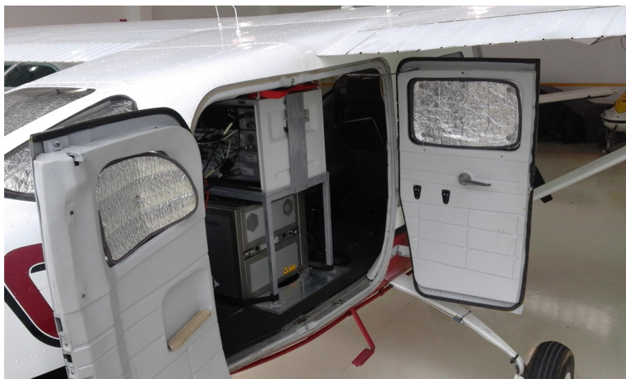
Figura 3.1 - Avião utilizado para coleta dos dados, onde se vê o sensor LiDAR instalado
