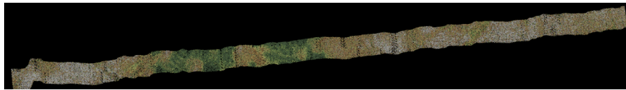
Figura 2.4 - Imagem criada a partir dos dados coletados em um voo LiDAR. As cores são artificialmente geradas a partir da altitude do ponto
