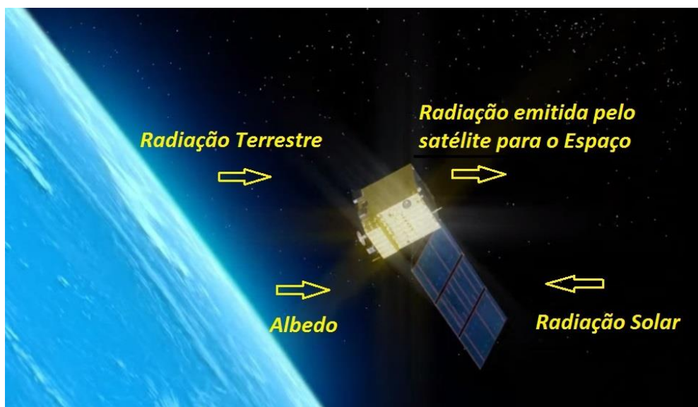
Figura 2.1. Ambiente térmico de um satélite em órbita da Terra.
