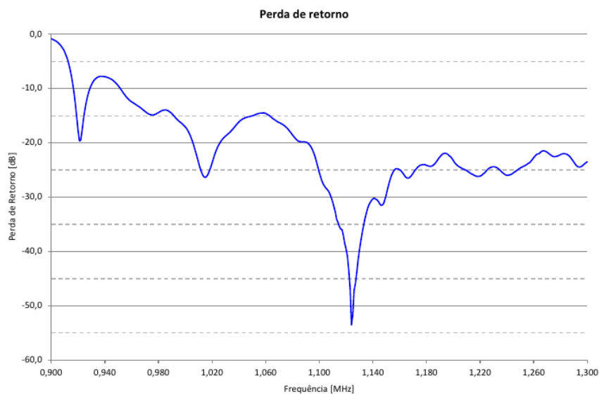
Figura 3.8 - Diagrama de perda de retorno do protótipo de uma corneta do BINGO.
