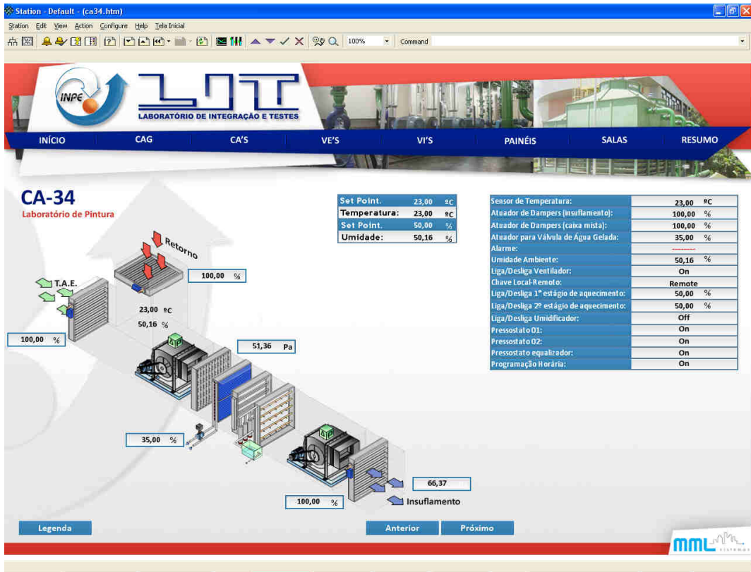
Figura 4 – Exemplo de equipamento sem indicação de alarme.
