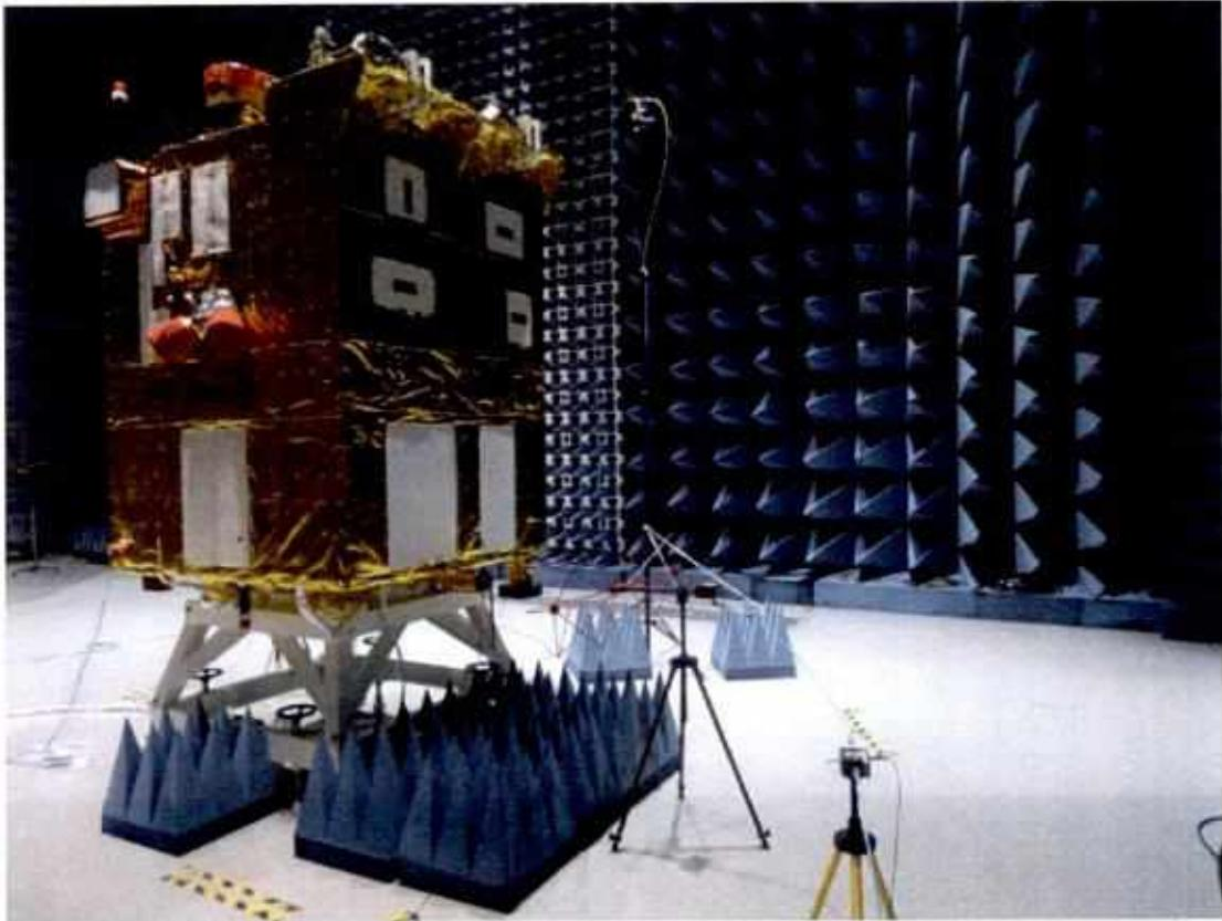
*Figura 13 – Configuração de equipamentos para ensaio do satélite CBERS*
