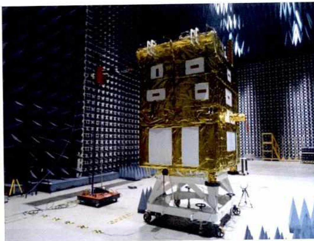
*Figura 9 – Configuração de equipamentos para ensaio do satélite CBERS*
