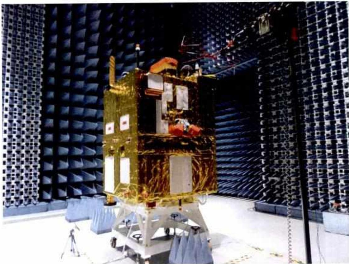
*Figura 12 – Configuração de equipamentos para ensaio do satélite CBERS*
