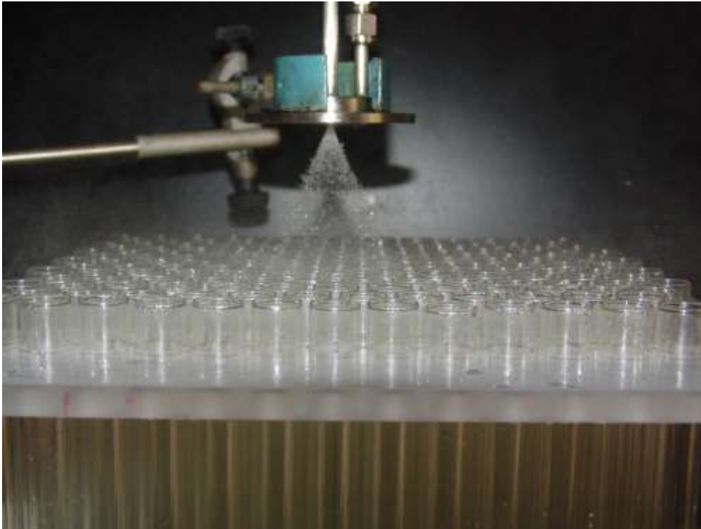
Figura 12.5 - Paternador com o injetor em teste.
