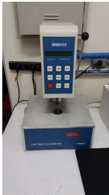
Figura 8.4 - Viscosímetro rotacional Brookfield para caracterização reológica.
