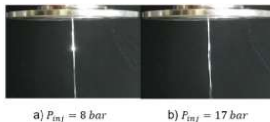
Figura 10.33 - Injetor centrífugo dual C operando em diversas pressões de injeção na câmara primária utilizando etanol gelificado como fluido de teste.
