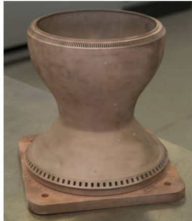
Figura 1.4 - Câmara de combustão fabricada com processo de impressão 3-D.
