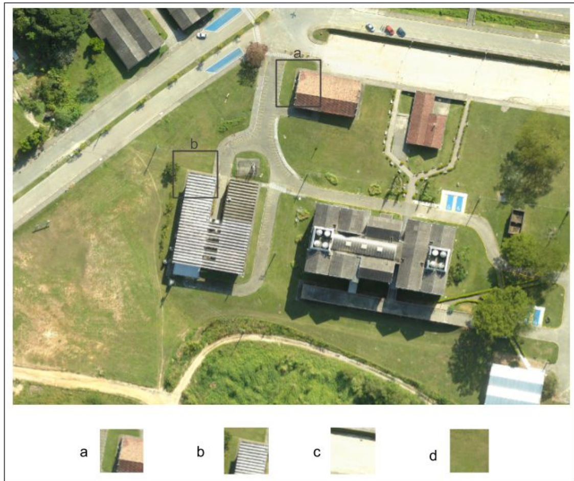
Figura 2.2 - Extração de patches para casamento entre as imagens.
