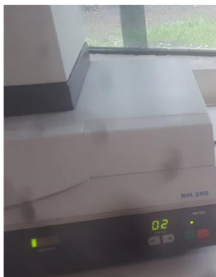
Figura 3.18 - Moedor automático para afinamento do nitrato de potássio.
