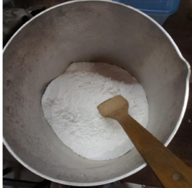
Figura 3.22 - Propelente sendo misturado com espátula.
