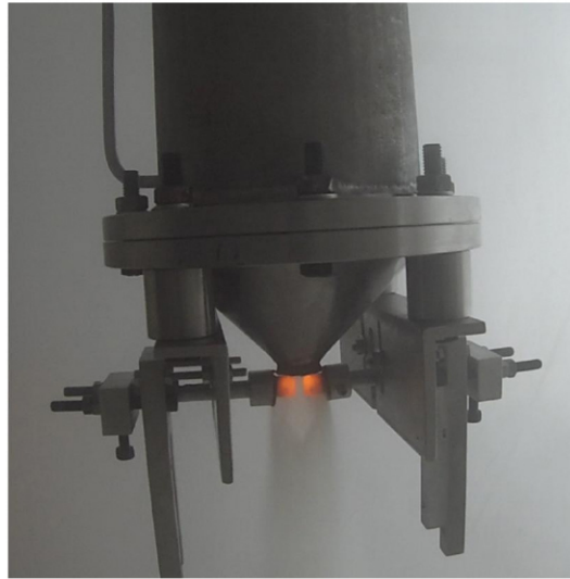
Figura 4.9 - Imagem capturada durante a queima no primeiro teste estático para caracterização do aerofólio.
