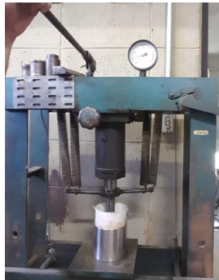
Figura 3.24 - Prensagem do grão propelente no molde utilizando 2 toneladas.
