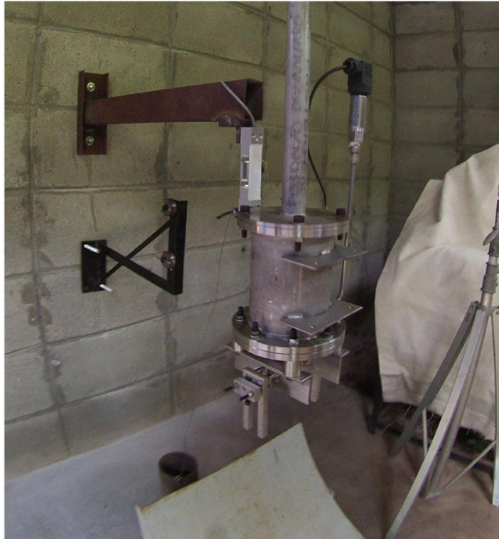
Figura 3.36 - Configuração final do experimento para a caracterização do aerofólio.
