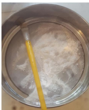
Figura 3.19 - Peneira para seleção da granulometria do nitrato de potássio.
