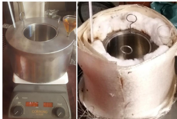
Figura 3.23 - Molde com banho maria sobre a placa de aquecimento e isolante térmico
