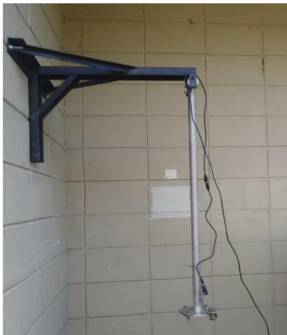
Figura 3.31 - Montagem do pêndulo para o teste.
