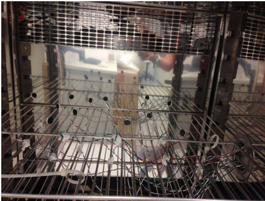
Figura 3.5 - Distribuição dos elementos sensores na câmara climática.
