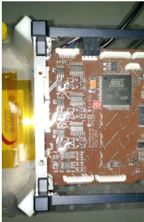
Figura 8 - Vista superior do computador de bordo do modelo de engenharia.
