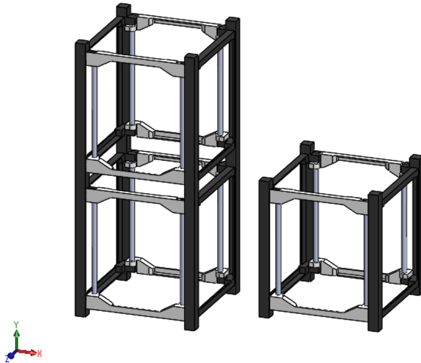
Figura 16 - Comparativo estruturas 1U e 2U.
