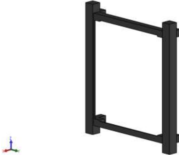
Figura 10 - Trilho acoplável externo 1U.
