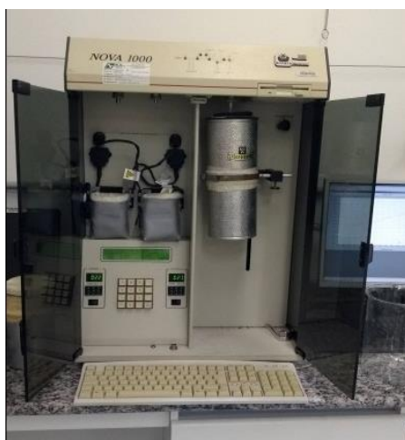
Figura 9 - Aparelho Quantachrome compreendendo duas estações: a de tratamento à esquerda; análise à direita.
