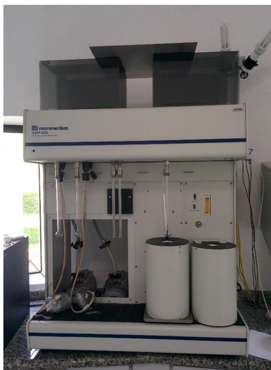
Figura 3.5 - Analisador de área específica da marca Micromeritics modelo ASAP 2020
