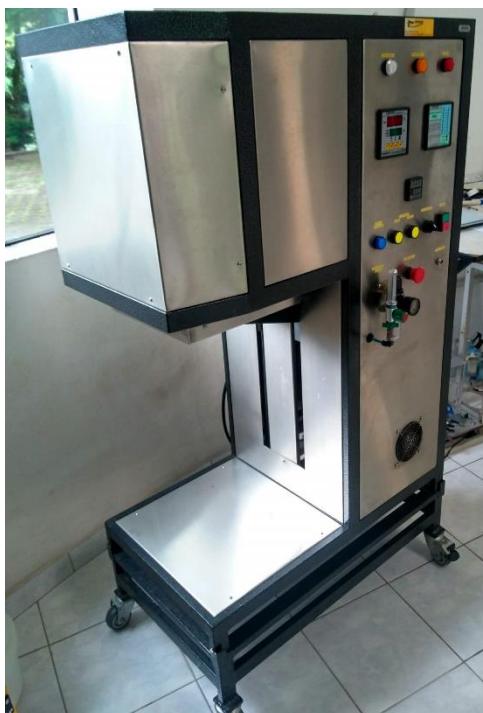
Figura 3.2 – Forno mufla marca Fortlab usado na calcinação
