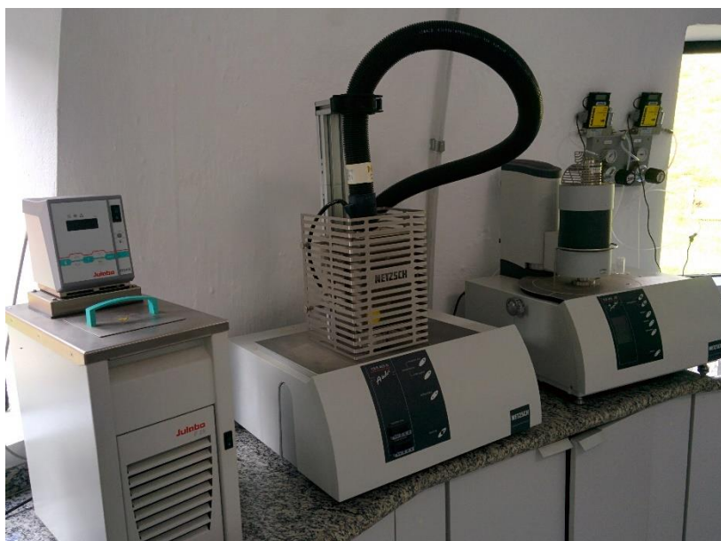
Figura 3.4 - Termobalança da marca Netzsch modelo STA 449F3 Júpiter
