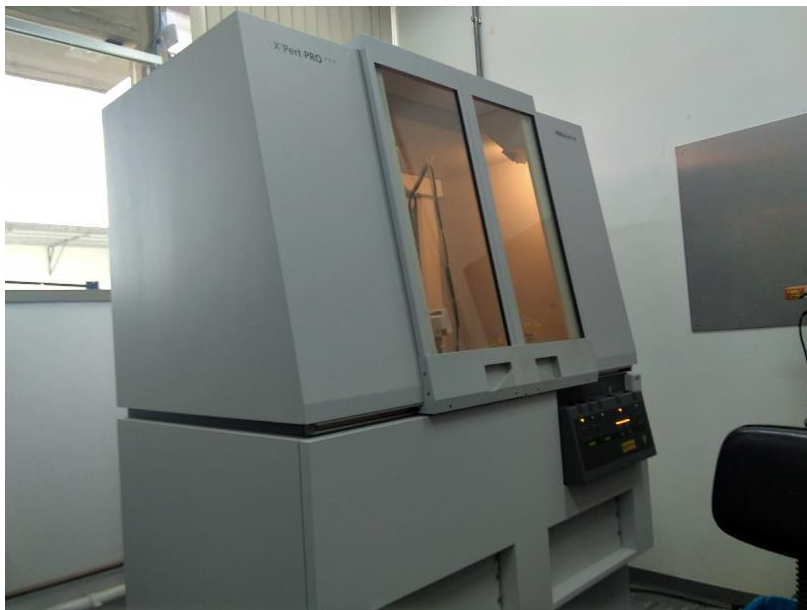
Figura 3.6 - Difratorômetro de raios X da marca Panalytical modelo X'Pert 3 Powder utilizado para estudo cristalográfico
