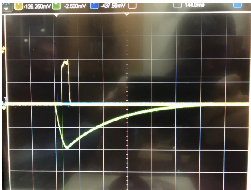
Figura 5.1 Sinais de corrente nas bobinas e do arco no osciloscópio Fonte: Autor
