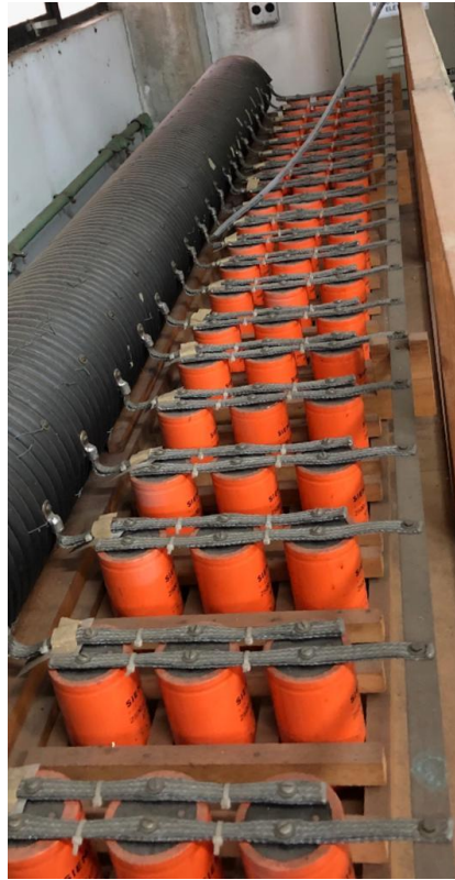
Figura 4.7 Banco de capacitores utilizado para geração do arco Fonte: Autor
