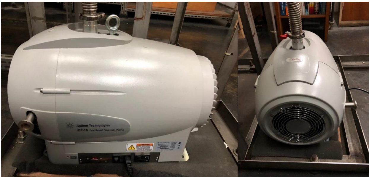
Figura 4.1 Bomba de vácuo Fonte: Autor
