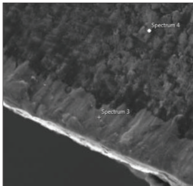
Figura 12: Pontos de leitura EDS em filme microcristalino.
