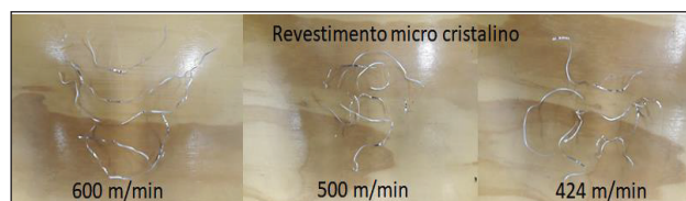
Figura 8: Cavacos gerados com inserto com revestimento nanocristalino.
