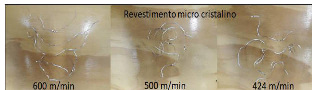
Figura 7: Cavacos gerados com inserto com revestimento microcristalino.
