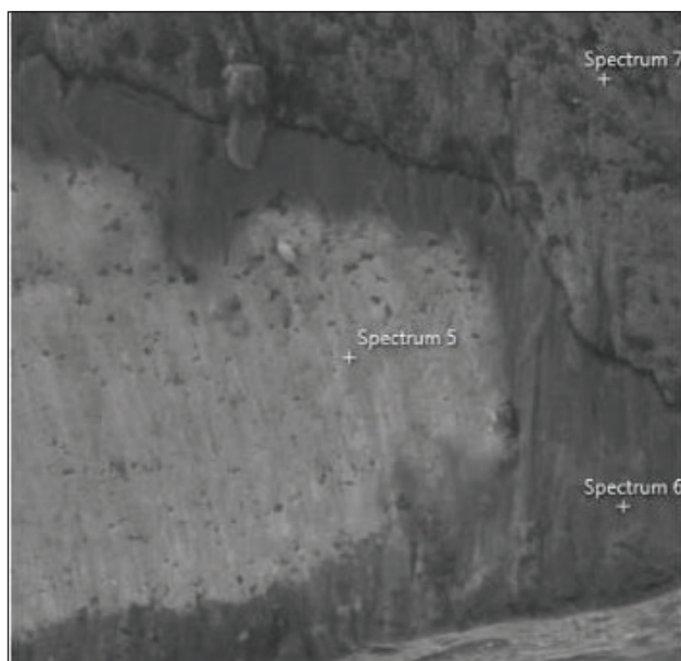
Figura 15: Pontos de leitura EDS em filme nanocristalino.
