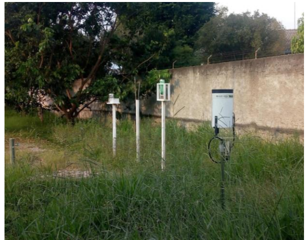
Figura 1 – Foto do pluviômetro artesanal no centro e pluviômetro de básculas semiautomático padrão CEMADEN à direita. Do autor (2019).
