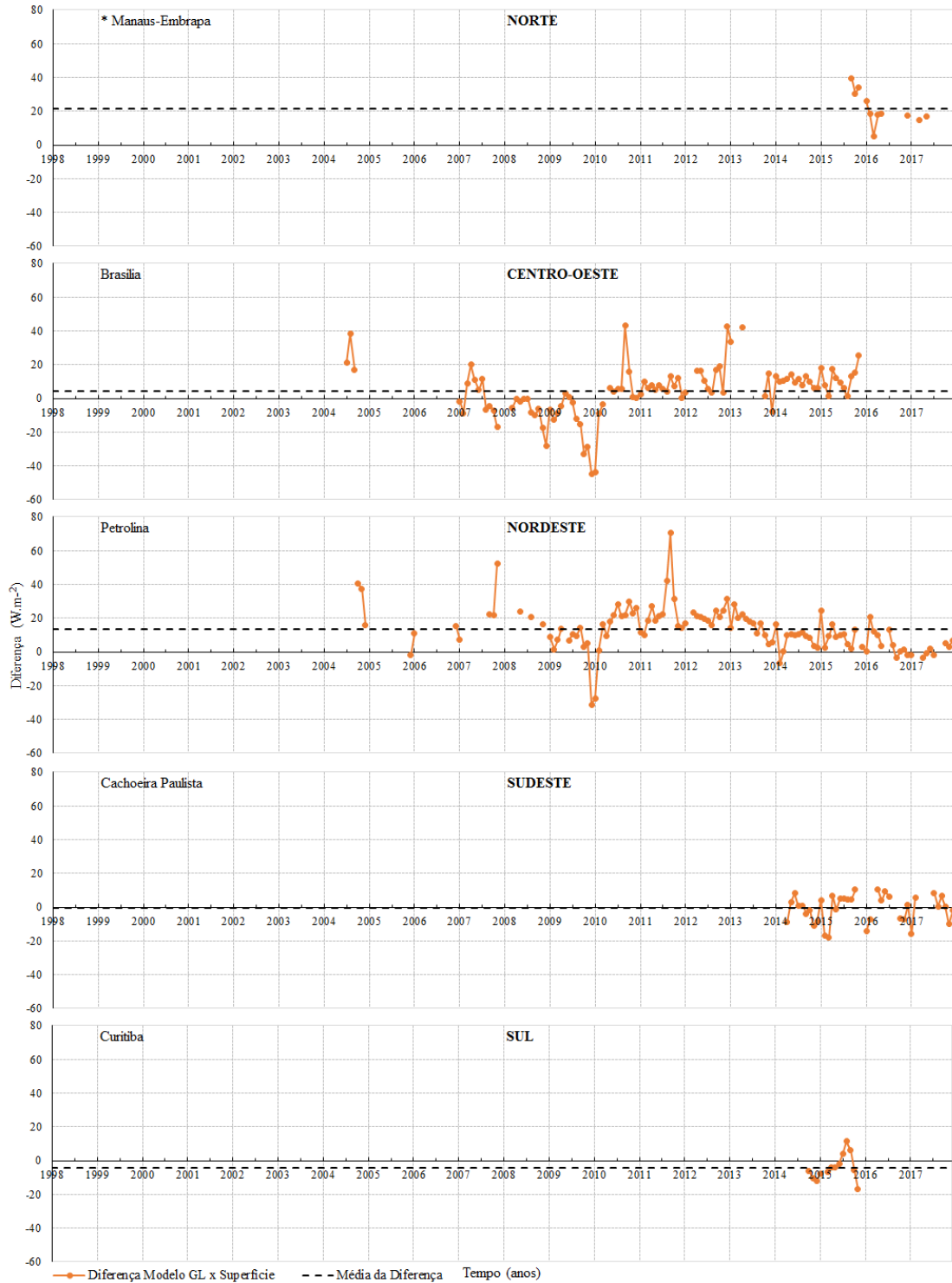
Figura 4.14 - Série temporal da diferença da irradiância média mensal do modelo GL e o valor obtido em superfície. Linha tracejada indica a média da diferença. Ver as séries temporais das outras estações no Apêndice Figura A.3.
