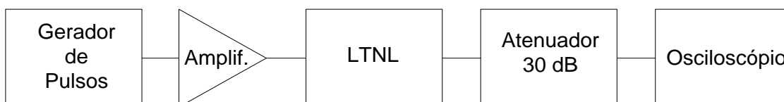
Figura 5.36 – Diagrama de blocos do setup de medição na carga resistiva.
