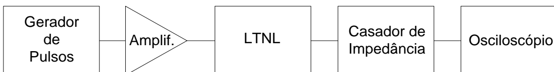
Figura 5.12 – Diagrama de blocos do setup de medição com casador de impedâncias.
