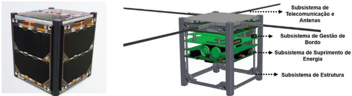
Figura 4.4 – Cubesat e sua estrutura de subsistemas.
