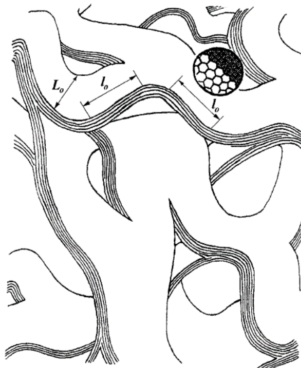
Figura 3.3 – Estrutura turbostrática do Carbono Vítreo.
