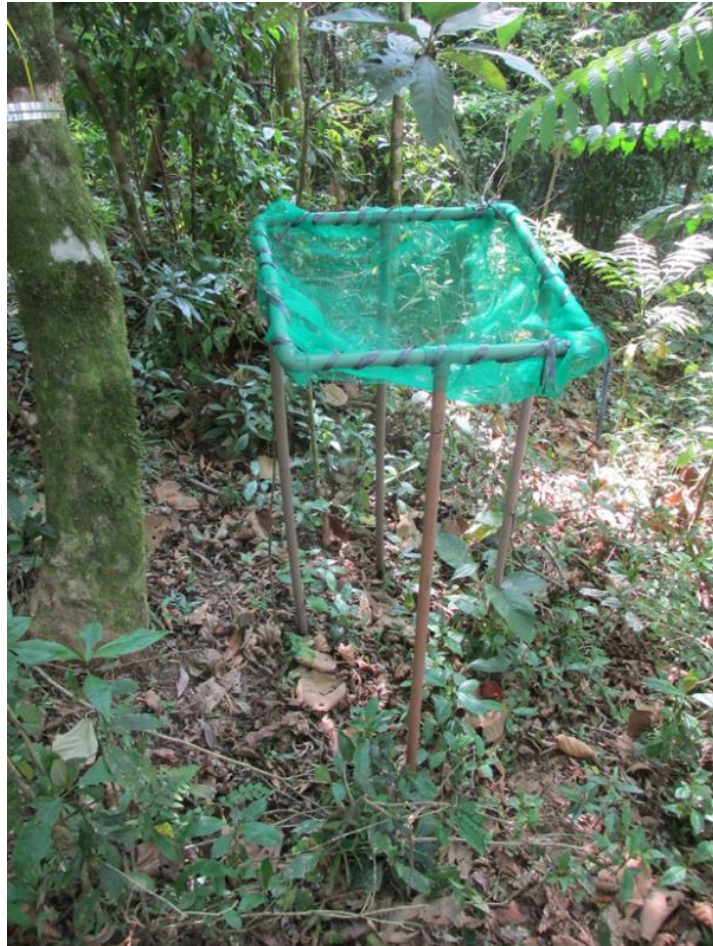
Figura 3.13 - Coletor de serrapilheira.
