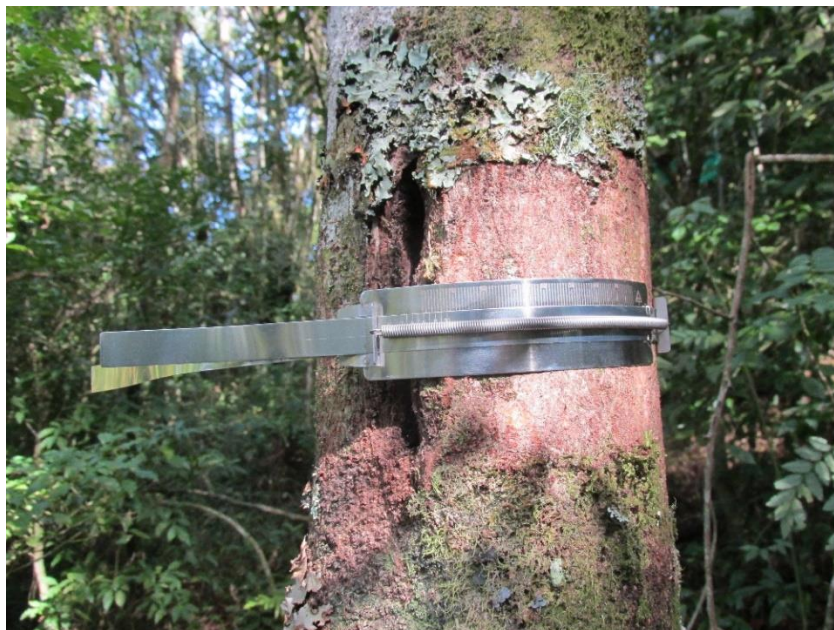
Figura 3.11 – Fita dendrométrica de banda metálica usada para medir o crescimento do tronco, distribuída em 60 indivíduos que foram monitorados durante o período de 2019.
