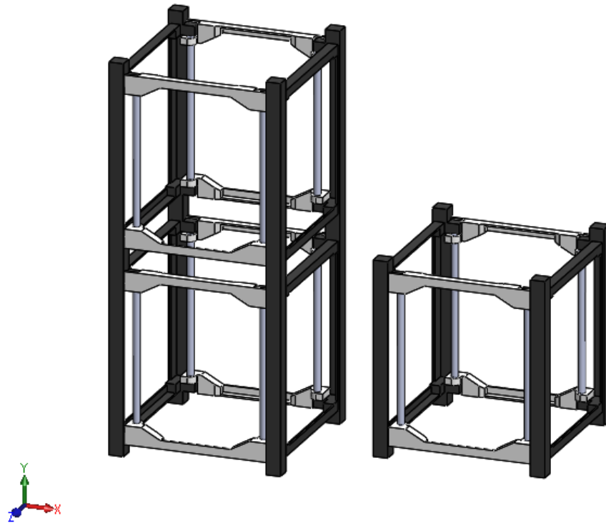
Figura 16 - Comparativo estruturas 1U e 2U.
