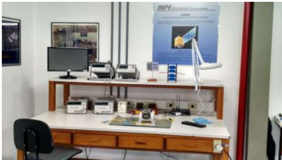
Figura 1 - Modelo de engenharia do NANOSATC-BR1 na Bancada de Testes do LITN
